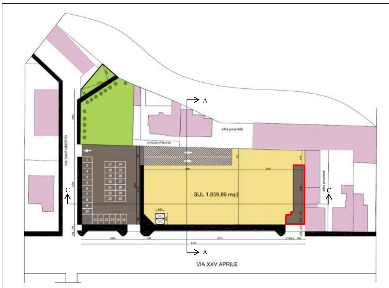
Figura 1.2-2 Planimetria del piano terra in progetto, con indicazione dell'area di carico/scarico merci (sagoma rossa)
